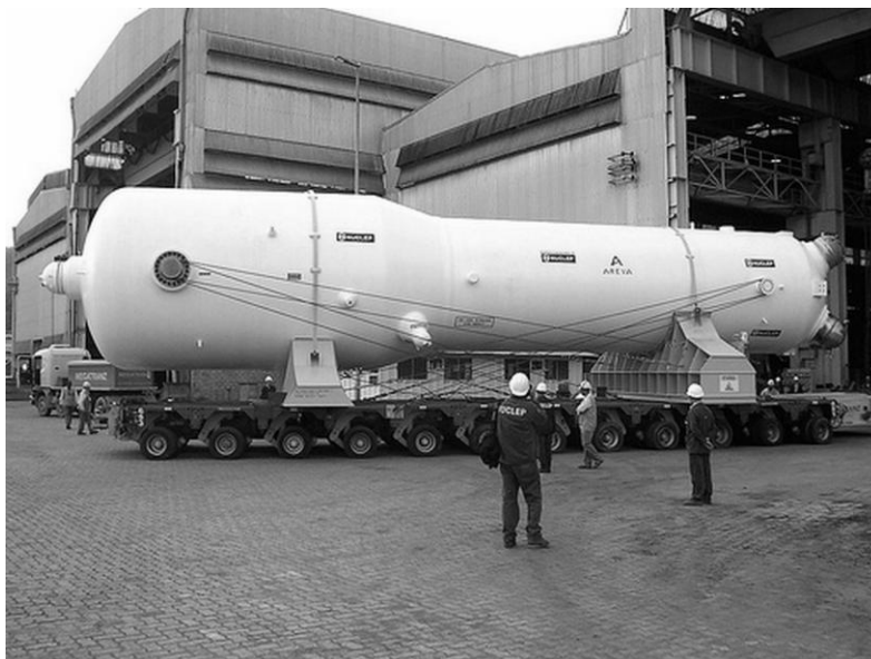
Transporte do novo gerador de vapor da fábrica da NUCLEP para Angra 1. Retirada do site da NUCLEP. Disponível em: < www.nuclep.gov.br >. Acesso em 10 abr. 2012.
