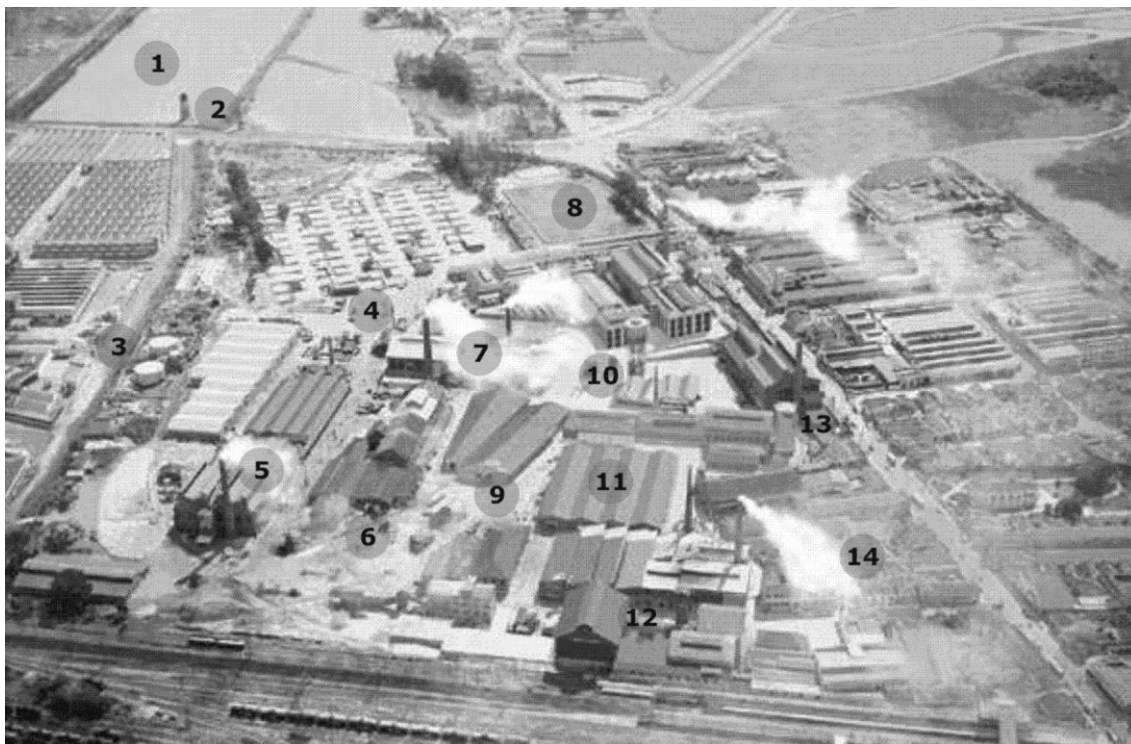
Figura 03: Vista aérea – comemoração de 50 anos da empresa. Legenda: 1. Um dos lagos naturais; 2. Castelo das bombas de água; 3. Reservatório de combustível; 4. Depósitos de garrafas; 5. Forno N° 14 para fabricação de artigos Pyrex; 6. Forno para fabricação de tubos; 7. Fornos automáticos para a fabricação de vidros e garrafas; 8. Praça de Esportes; 9. Armazéns de matérias primas; 10. Seção de tratamento de areia; 11. Armazéns para depósitos e embalagens de vidros; 12. Fornos semi-automáticos para a fabricação de vidros; 13. Forno N° 12 para a fabricação de automática de garrafas; 14. Conjunto residencial para empregados (Vila Velha). Fonte: Acervo da Empresa (adaptada pelo autor).
