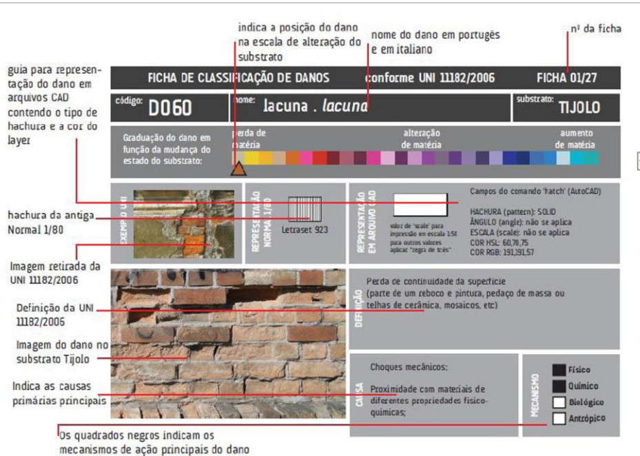
Figura 4: Um ‘Fichas de Classificação de Danos’. elaborada para subsidiar observações in situ e realização de Mapa de Danos. Elaboração: Rodolpho Henrique Correa, 2011. Arquivo Gcor-Arquitetura Unicamp
